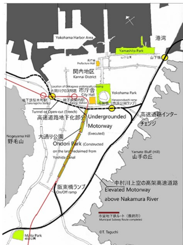
図-16 高速道路変更後（派大岡川を地下化、インターチェンジを中村川に移設）（筆者作図）
